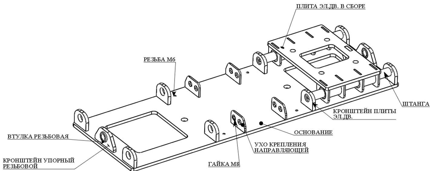
*ПРИМЕЧАНИЕ: для обеспечения соосности детали «Кронштейн плиты эл.дв.», перед проведением сварочных работ необходимо установить «Штангу» и «Плиту эл.дв. в сборе» рисунок 2. Гайку М8 вставить в «Ухо крепления направляющей», выступающая часть во внутрь и приварить.*
