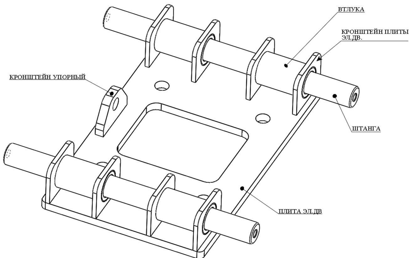
*ПРИМЕЧАНИЕ: для обеспечения соосности детали «Втулка», перед проведением сварочных работ необходимо установить «Штангу» смотреть рисунок 1.*
